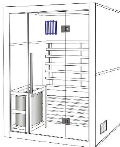
(12) Przymocuj lampy na przygotowanych hakach i złącz kable na dachu
