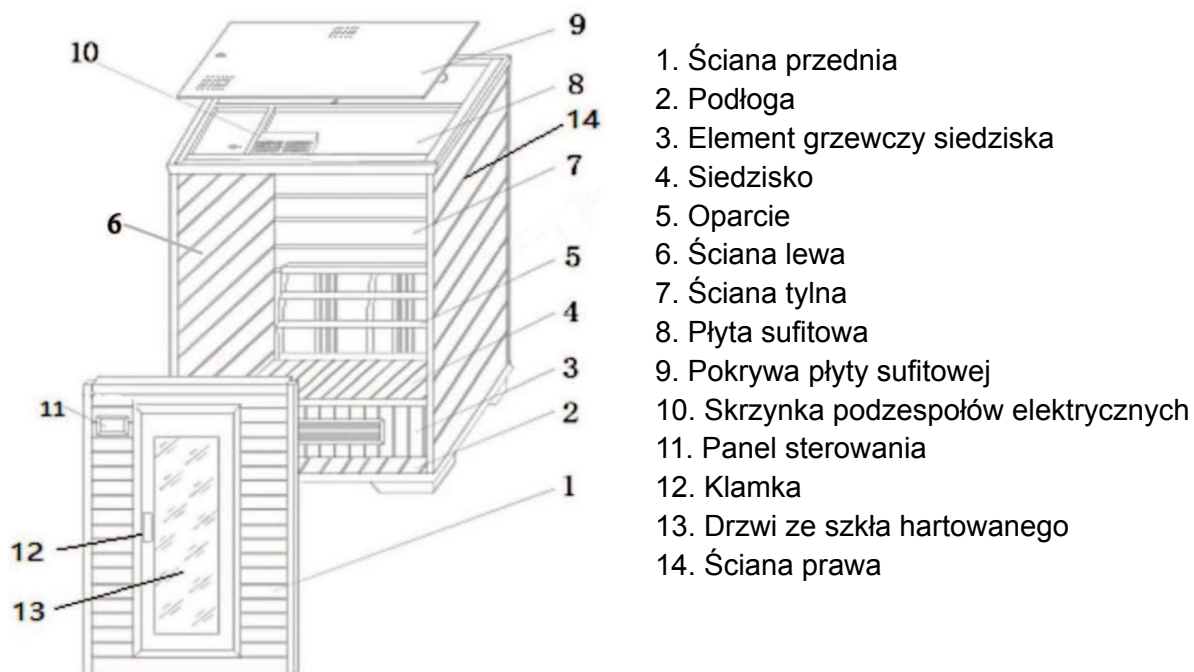
Rys. 3. Oznaczenie poszczególnych elementów sauny infrared
